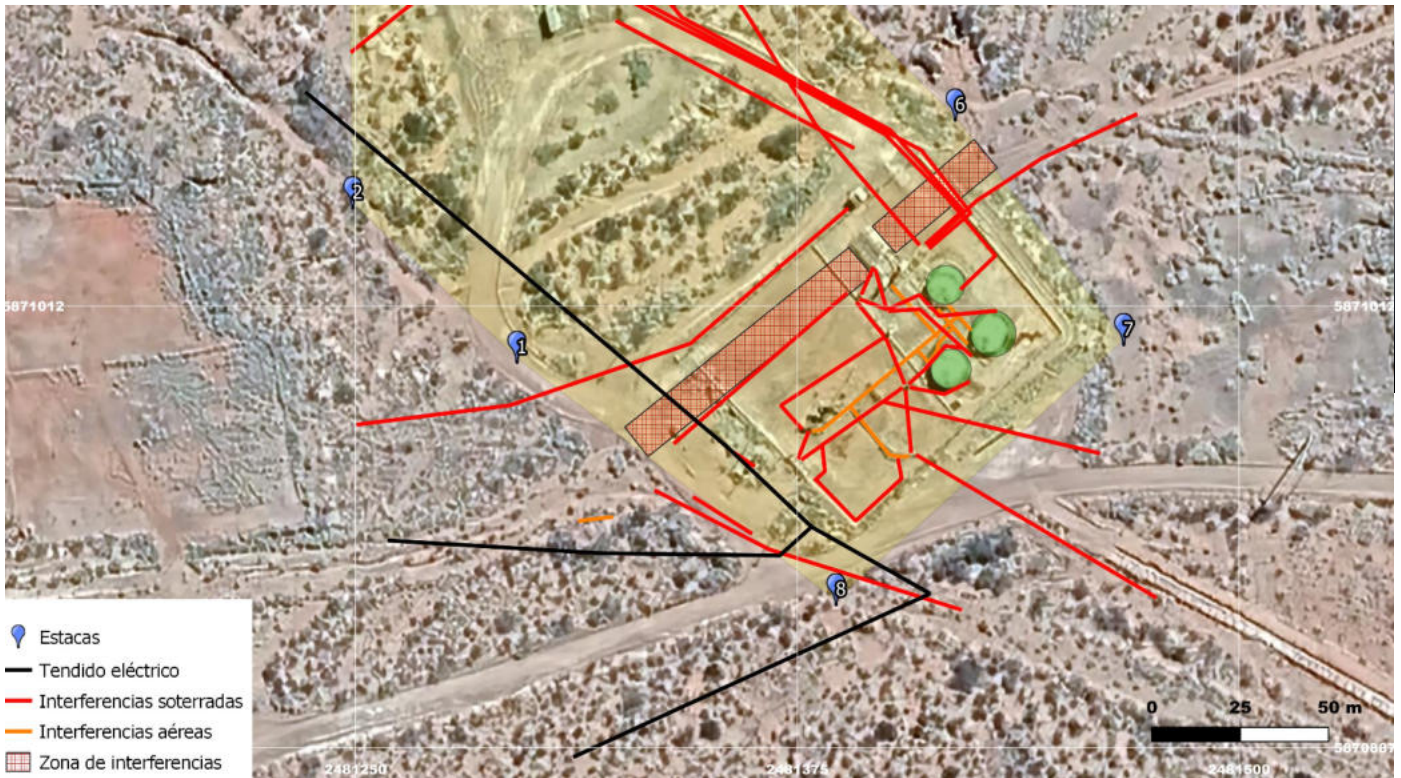
EJ: PLANO DE INTERFERENCIAS SOTERRADAS.
