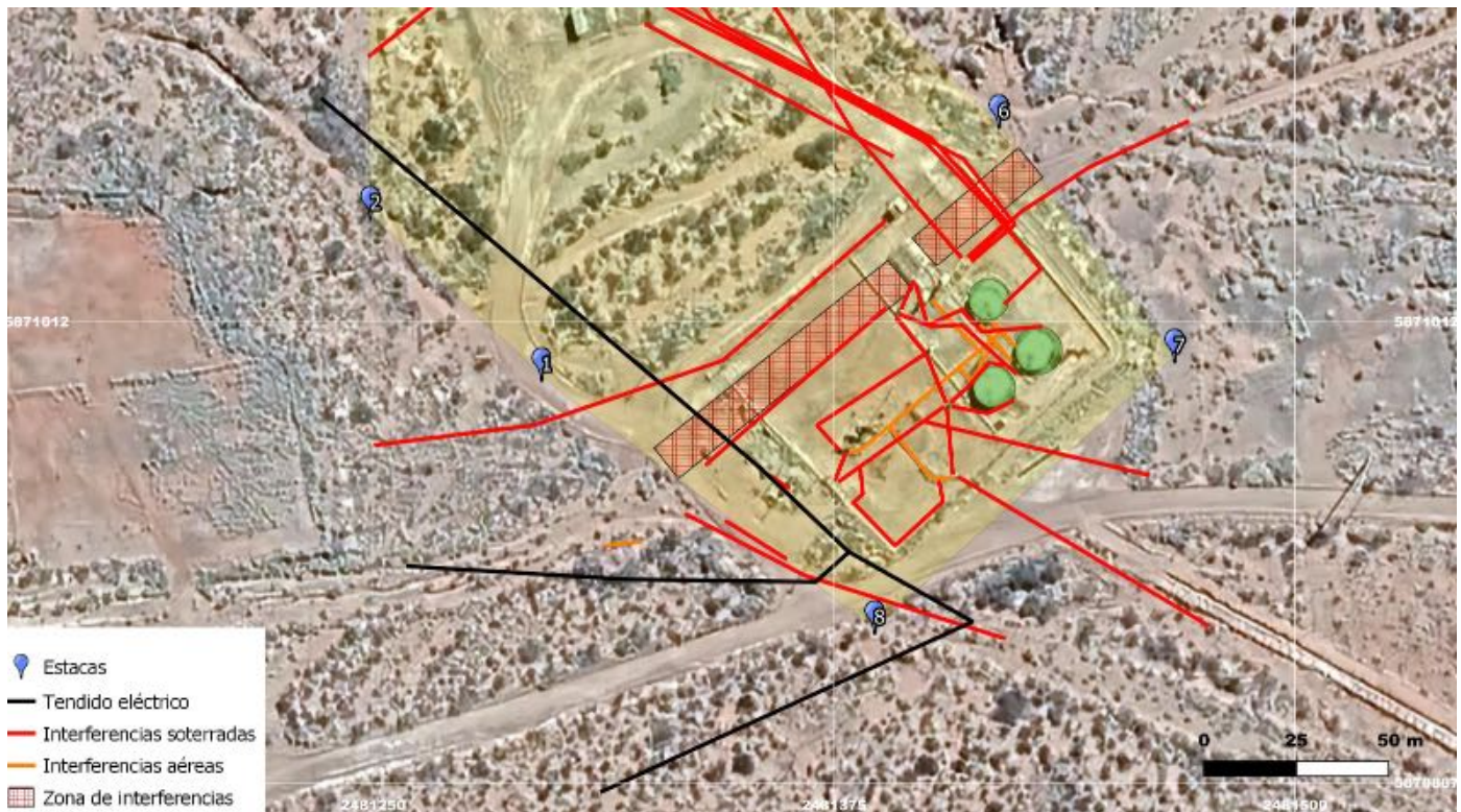
EJ: PLANO DE INTERFERENCIAS SOTERRADAS.
