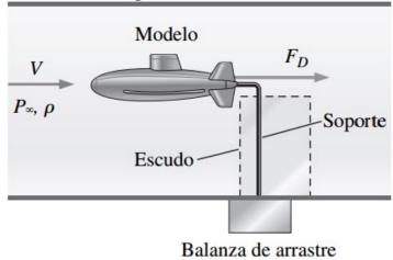
simulación?. Si la fuerza de arrastre medida es de 2,3N. Estime la fuerza de arrastre sobre el submarino prototipo en las mismas condiciones.
