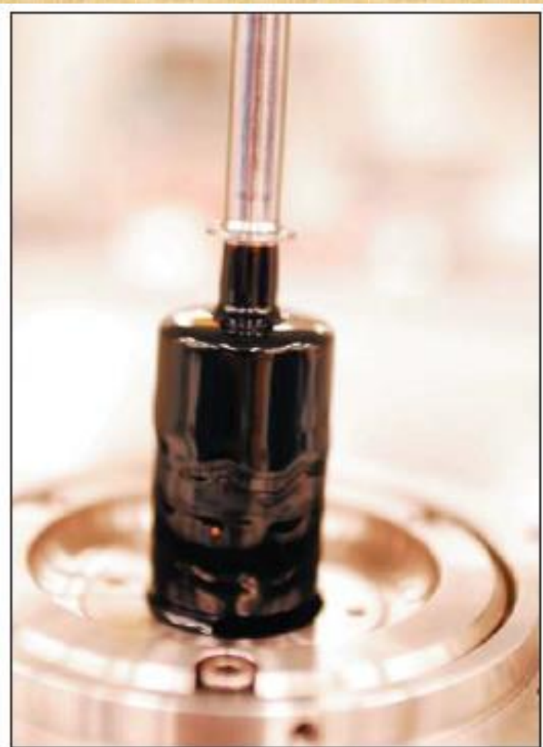
^ Medici6n de la viscosidad del petr6leo viscoso con un re6metro. Los re6metros miden los cambios producidos en la viscosidad con la variaci6n de la tasa de flujo. Esto es importante para la caracterizaci6n de los petr6leos viscosos que exhiben un comportamiento no Newtoniano, lo que significa que su viscosidad es una funci6n del 6ndice de cizalladura (corte).
