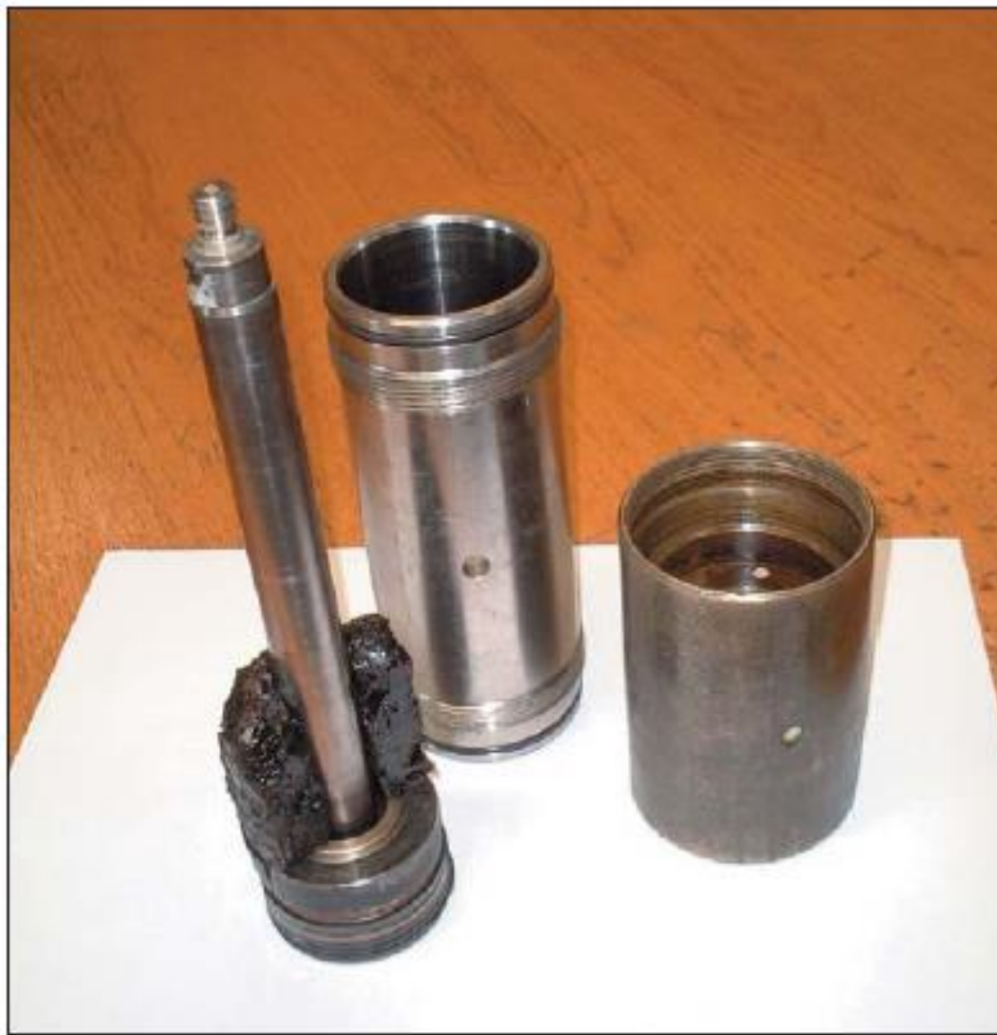
^ Petr6leo pesado sudamericano de alta viscosidad adquirido mediante operaciones de muestreo con cable.
