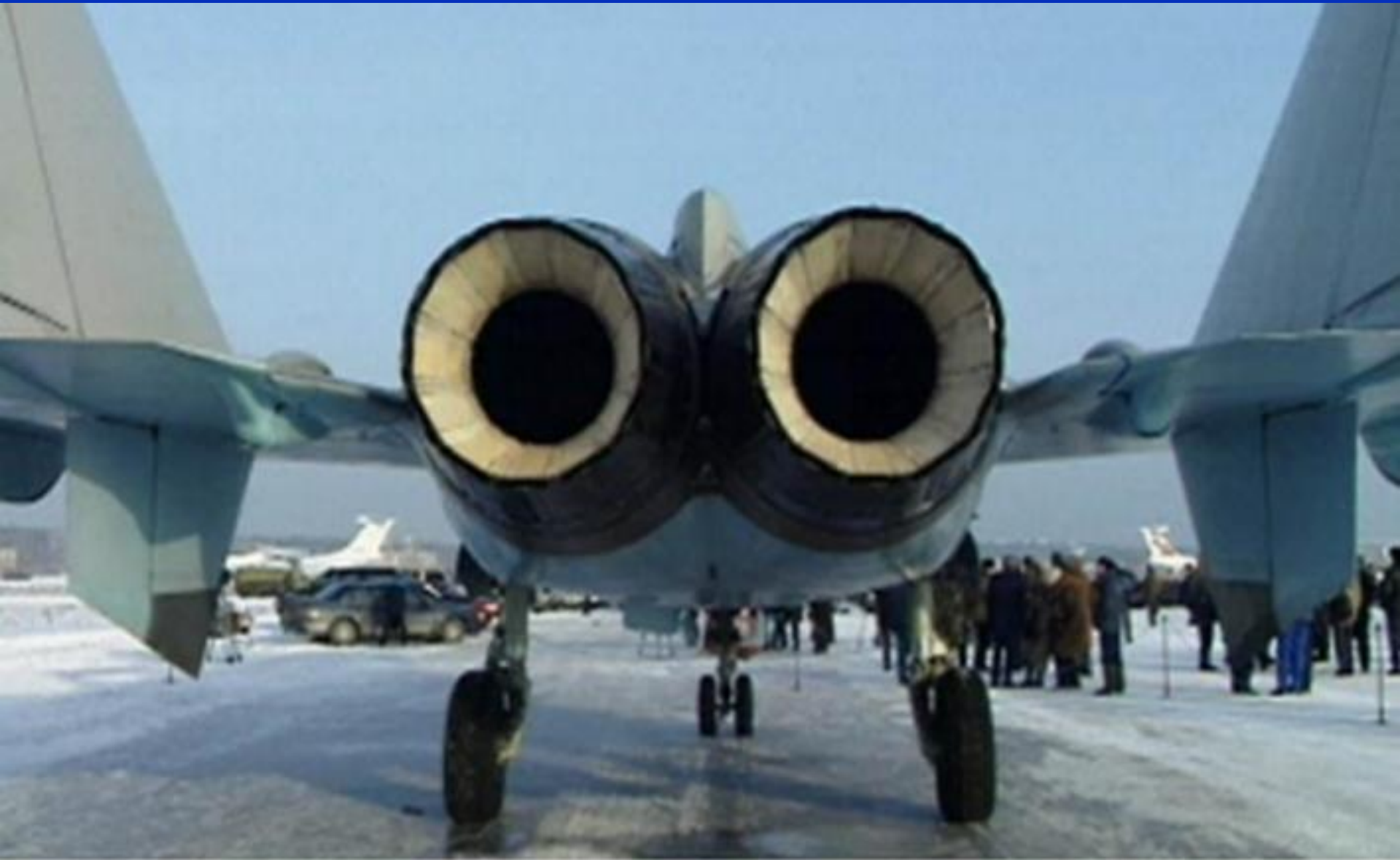
Fig. 2.22 Detalle toberas del MiG 1.44
